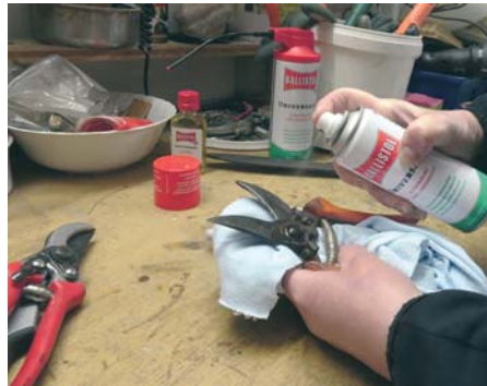
Gartengeräte benötigen vor der Winterpause Zuwendung. Ein Ölfilm bewahrt sie vor Korrosion. Foto: Ballistol GmbH
